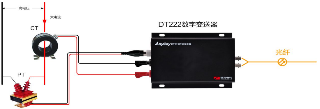
DT 直接测量接线
