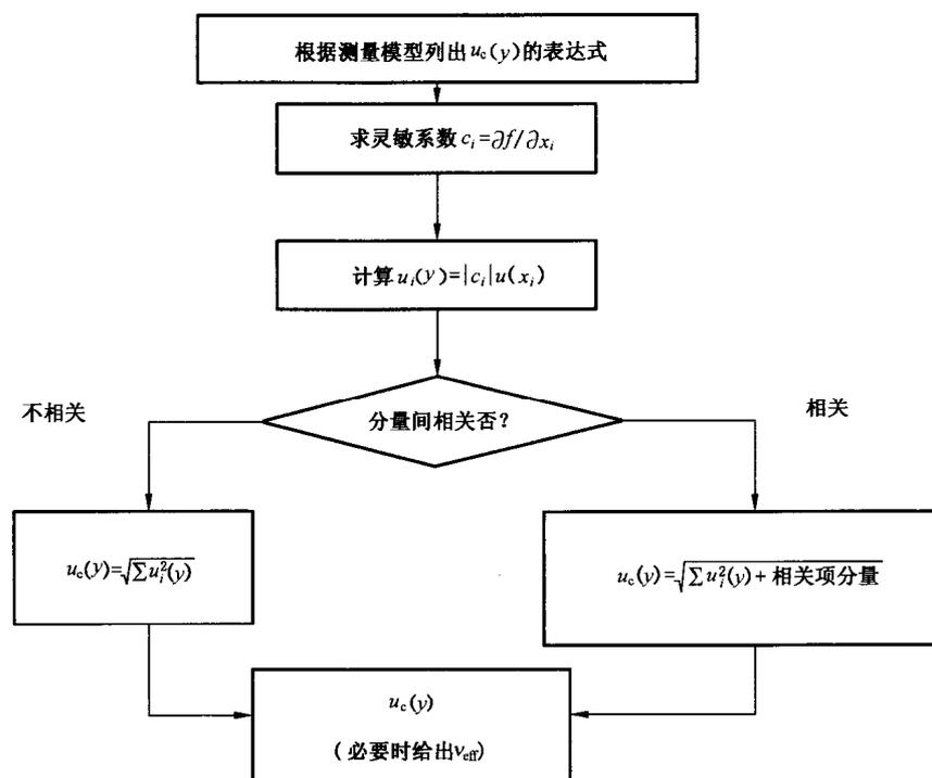
图 4 合成标准不确定度计算流程图
