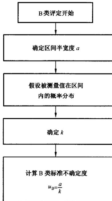
图 3 标准不确定度的 B 类评定流程图
