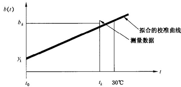
图 A.1 最小二乘法拟合的示意图
