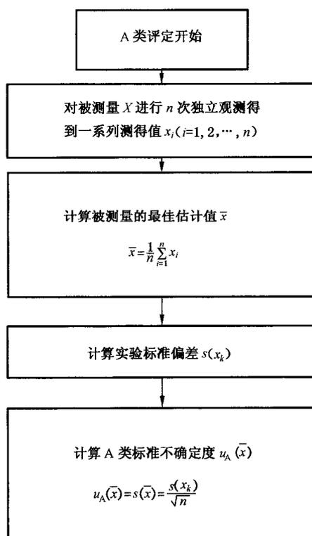
图2 标准不确定度的A类评定流程图
