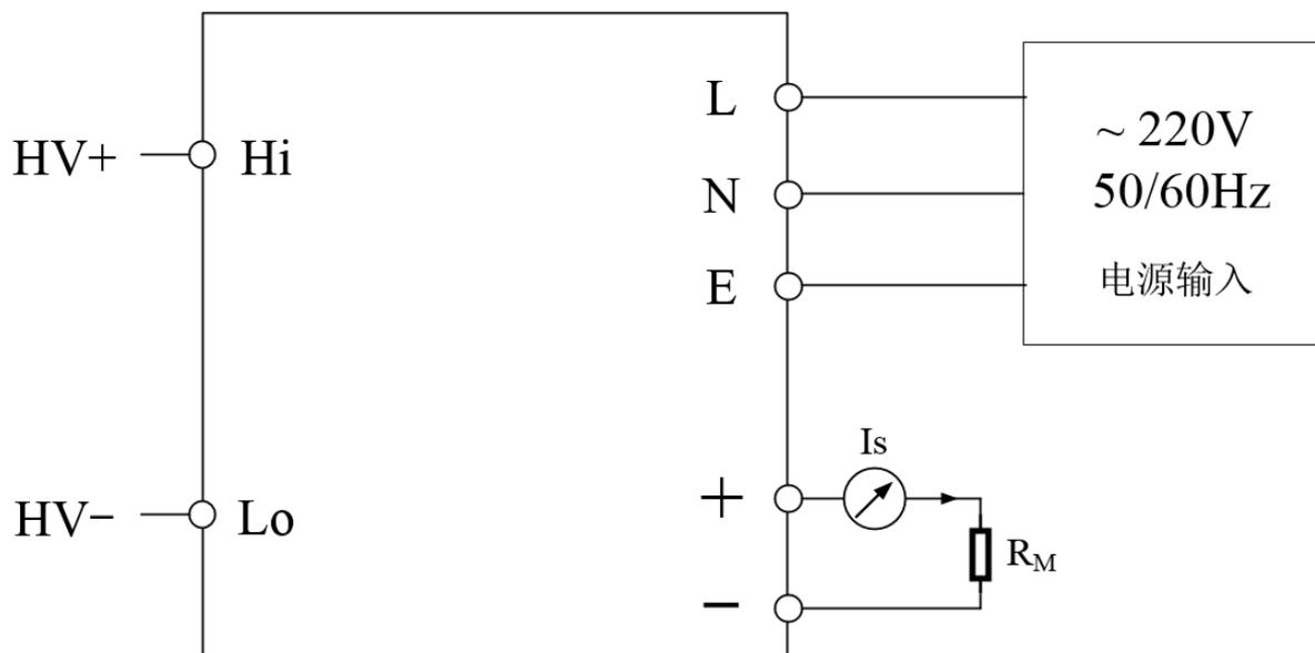
图 3 电气连接图
